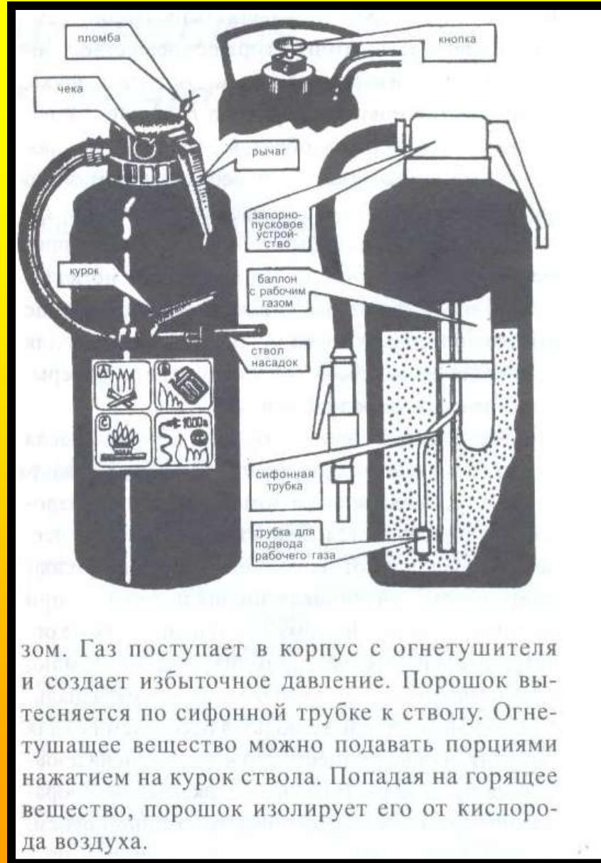
зом. Газ поступает в корпус с огнетушителя и создает избыточное давление. Порошок вытесняется по сифонной трубке к стволу. Огнетушащее вещество можно подавать порциями нажатием на курок ствола. Попадая на горящее вещество, порошок изолирует его от кислорода воздуха.
